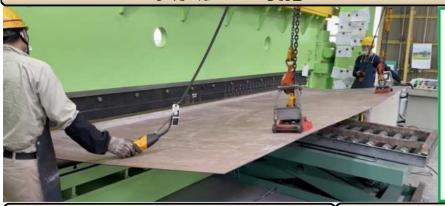
耐摩耗鋼のHARDOXでも SS材と同じく6メートルの長さまで 曲げ加工可能ですので 是非ご注文ください!
